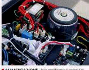
ALIMENTAZIONE - In un amplificatore di potenza l'alimentazione è di fondamentale importanza: Advance Accustic dimostra di tenere in massima considerazione questo aspetto, utilizzando per la parta audio un trasformatore toroidale ben dimensionato.
